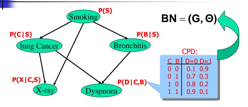
$$P(S, C, B, X, D) = P(S) P(C|S) P(B|S) P(X|C,S) P(D|C,B)$$
